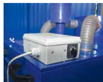
Пульт управления с реверсивным выключателем
