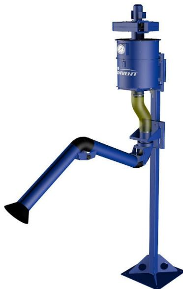
4.4.2. **Комплектация ФМТ-1000-К-2:** фильтр масляного тумана в настенном исполнении ФМТ-1000-Кр с установкой на колонне высотой 3,3 м с вытяжным шлангом, закрепленным на консоли 3,2 м, и круглым зонтом Ø750 мм (см. рис. 5).
