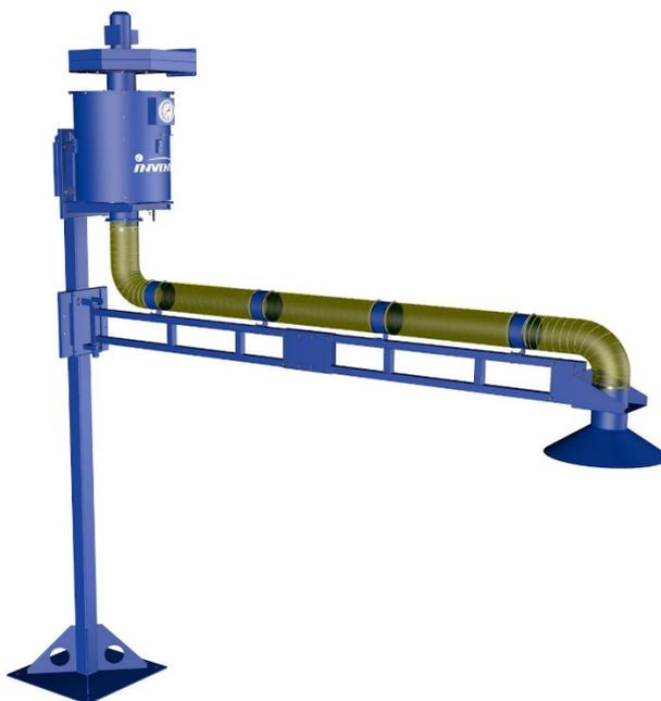
4.4.3. **Комплектация ФМТ-1000-К-3:** фильтр масляного тумана в настенном исполнении ФМТ-1000-Кр с установкой на колонне высотой 3,3 м с вытяжным шлангом, закрепленным на консоли 3,2 м, и прямоугольным зонтом 500 x 500 мм (см. рис. 6).
